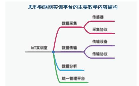
思科物联网实训平台，包括传感器、传感器网关、工业互联网设备（工业以太网交换机、工业路由器）、雾计算节点、服务器和大数据分析系统等组成。系统将传感器采集的数据通过工业互联网传输给雾计算节点进行数据初步处理，进而决定机器人、HMI等装置如何进行实时处理，最终传送到云端的大数据分析系统进行数据分析和决策。
